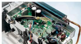
U spoljašnjoj jedinici se nalazi specijalno kućište koje štiti elektronske komponente i osigurava rad čak pri temperaturi od 85°C ali takođe i pruža zaštitu od štetnog požara.
