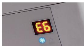
Ako dođe do problema u radu jedinica se automatski isključuje kako bi zaštitila sistem. Sistem pametne dijagnostike signalizira kod za brzu dijagnostiku i otklanjanje zastoja.
