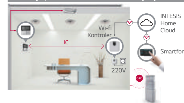
Slučaj 2) Veza sa kanalskim unutrašnjim jedinicama
